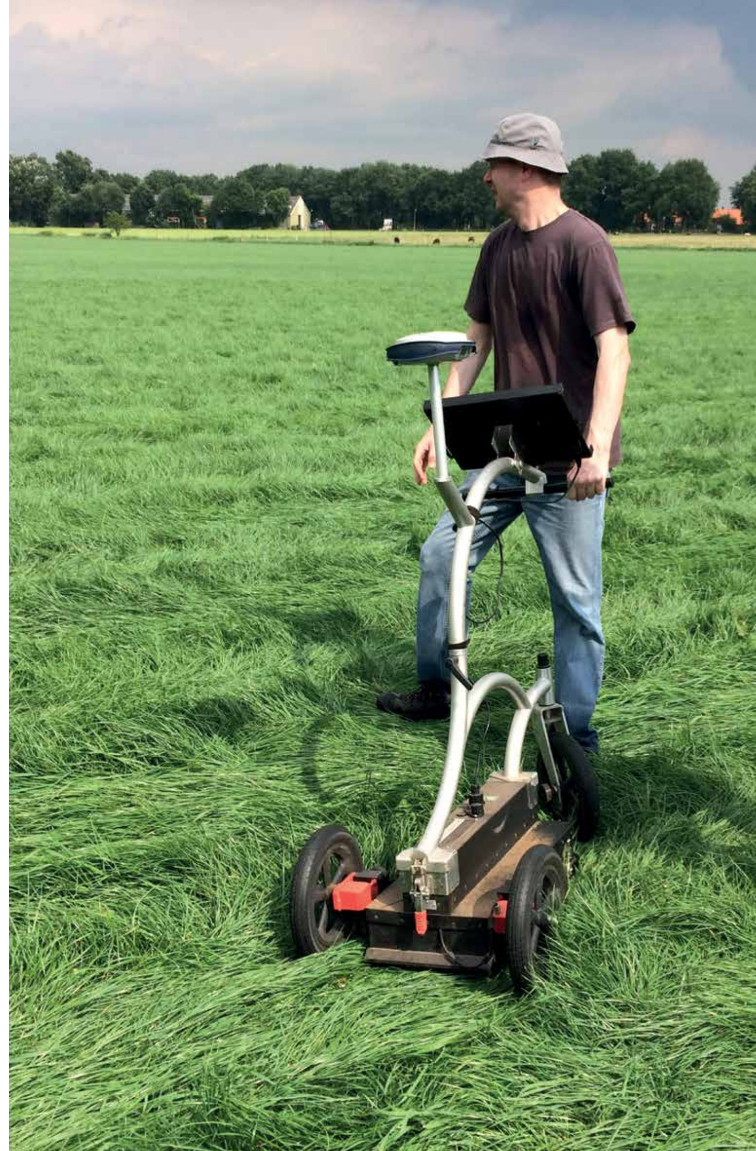
Afbeelding 3. Grondradaronderzoek met de Erfgoedradar te Luttenberg. Karretje met daaraan 'de radarbak', een GPS-GNSS-schotel (positionering) en veldcomputer voor de aansturing en opslag van de meetgegevens.
